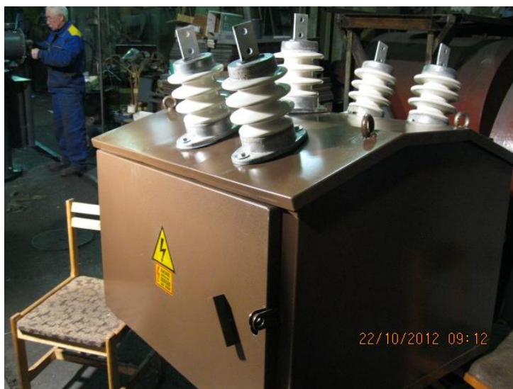
Фото 1. Пункт коммерческого учета электроэнергии типа ПКУЭ сх.2ТТ+3ТН
