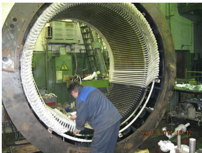
Фото 13. Замена обмотки статора эл/дв 10 кВ ДВДА2-235 Калининская АЭС, концерн «РосАтом»
